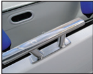
Ferrure en acier spécial sur coque en alu
