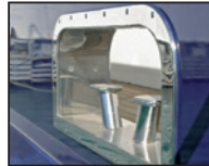
Ferrure en acier spécial dans bordé en alu
