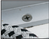
Vis en VA sur rambarde en alu
