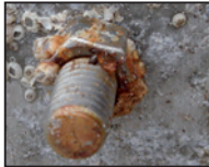
Vis en VA corrodée dans surface en alu
