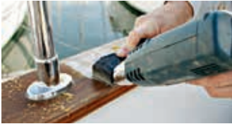
Oude laklagen met een hetelucht pistool verwijderen
