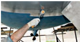
Hempel's High Protect II met verroller opbrengen
