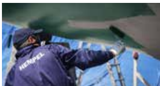
Antifouling opbrengen over primer of hechtverbeteraar
