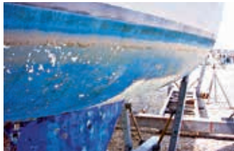
Verfblaasjes en omhooggetrokken verf
